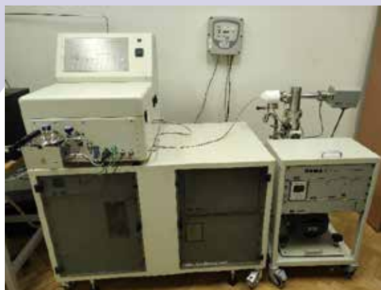
Aparat Sieverta (IMI HTP Hiden Isochema) połączony ze spektrometrem masowym.
