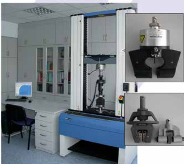
Maszyna Wytrzymałościowa INSTRON Model 3382, maksymalne obciążenie 100 kN
