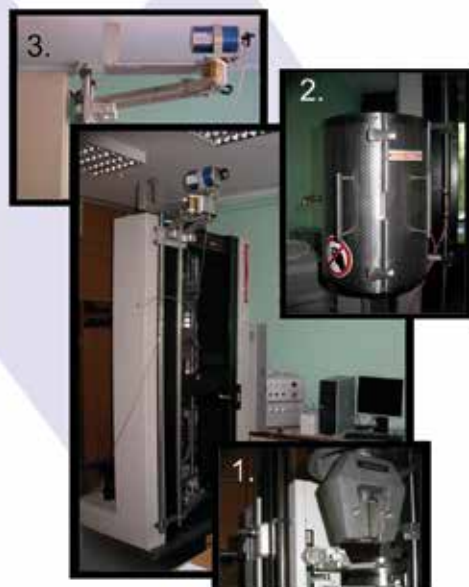
Maszyna Wytrzymałościowa INSTRON Model 6025 zmodyfikowana przez firmę ZWICK/ROELL, maksymalne obciążenie 100 kN 1. Makroekstensometr 2. Piec wysokotemperaturowy 3. Ekstensometr wysokotemperaturowy
